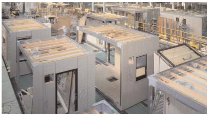
コンピュータ管理による工場ラインで生産することにより、高性能・高品質・高効率な家づくりを実現
