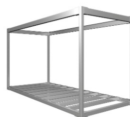
鉄骨系「セキスイハイム」の ボックスラーメン構造
