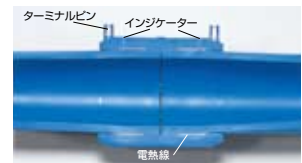
EFソケットの構造
