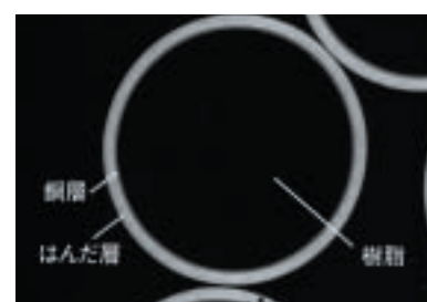
マイクロパールSOLの断面顕微鏡写真
