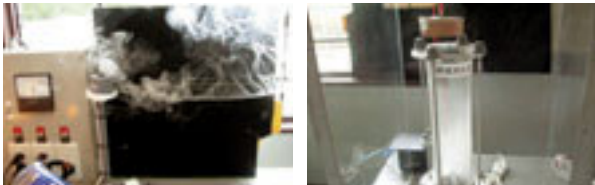
タコ足配線での過電流による火災の体感 小麦粉を使用するの粉じん爆発の体感
