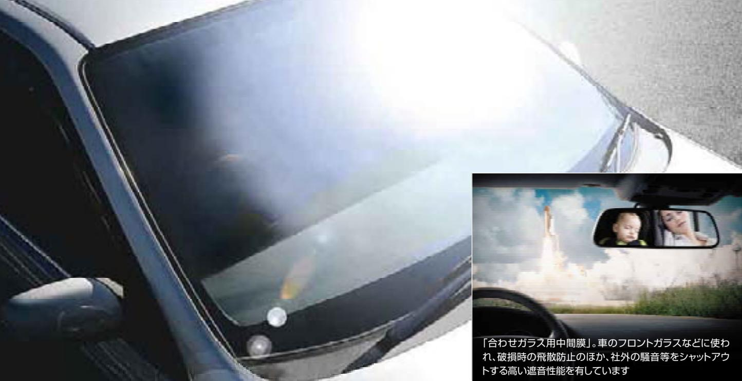
「合わせガラス用中間膜」。車のフロントガラスなどに使われ、破損時の飛散防止のほか、社外の騒音をシャットアウトする高い遮音性能を有しています
