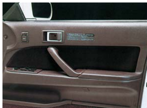
遮音性・軽量性・成型加工性に優れた自動車内装用発泡ポリオレフィン「ソフトロン®」
