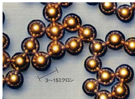
マイクロパールに金メッキを施し、導電性を持たせた微粒子「マイクロパール®AU」は、液晶や実装分野の高集積化を進めます。
