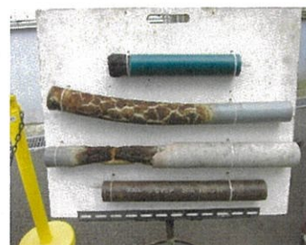
<耐火VP燃焼実験結果/管種別燃焼実験結果を比較します>
