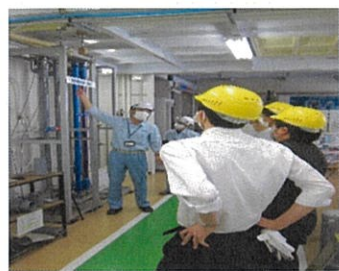
<排水管と給湯管の熱伸縮実験をします>
