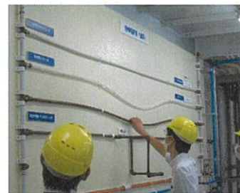
<排水管と給湯管の熱伸縮実験をします>
