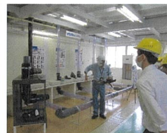
<実際にパイプを切断したり、単管式排水システムの排水実験をします>
