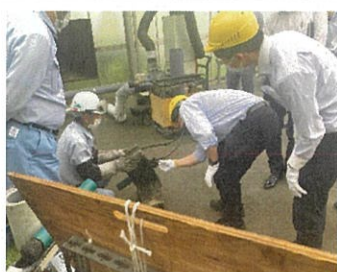
<耐火VP燃焼実験/実際にバーナーで炙ります>
