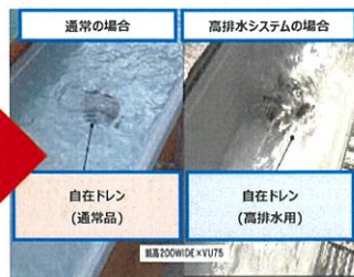
＜高排水ドレン使用時と通常ドレン使用時の軒とい内の水深の違いで排水性能を確認して貰います＞
