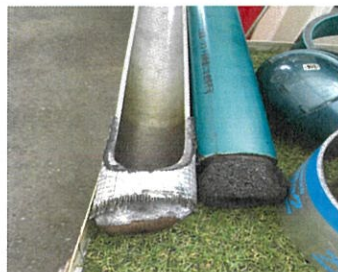
<耐火VP燃焼実験結果/管種別燃焼実験結果を比較します>
