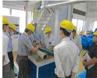
<耐火VPと耐火二層管/耐火集合管継手と鉄管集合管継手の重量比較をします>
