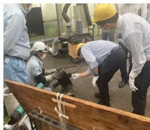
＜耐火VP燃焼実験/実際にバーナーで炙ります＞
