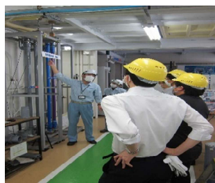
＜排水管と給湯管の熱伸縮実験をします＞
