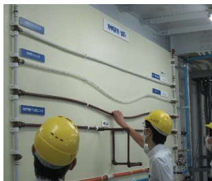
＜排水管と給湯管の熱伸縮実験をします＞
