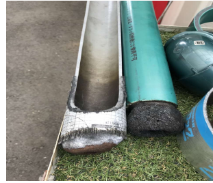
＜耐火VP燃焼実験結果/管種別燃焼実験結果を比較します＞
