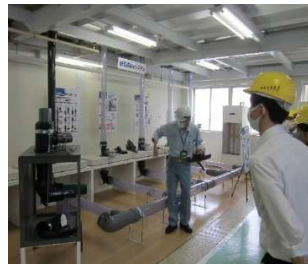
＜実際にパイプを切断したり、単管式排水システムの排水実験をします＞
