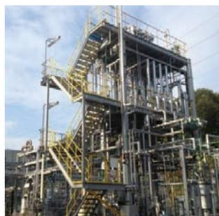
ごみをエタノールに変換できる世界初の技術を用いたパイロットプラント
