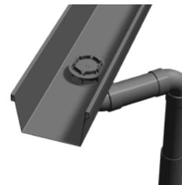
サイフォン式雨水排水システム。配管口径をUPすることなく、集中豪雨に対応する排水量確保。
