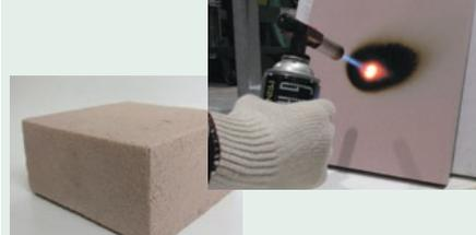
有機材料としては初めて「国土交通大臣不燃材料認定」を取得したウレタン系現場発泡断熱材です。現場での引火などに起因する火災事故の防止に寄与します。
