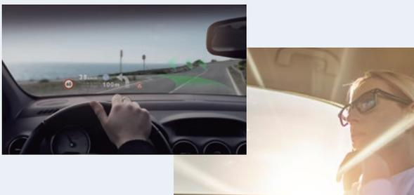
遮熱中間膜は、自動車ガラスの遮熱性を高め、日射しによる車内の温度上昇を軽減し、エアコン負荷を抑えます。当社が実施したEVでの実車評価では約20%の消費電力の削減が確認されました。EVの省エネ、航続距離の延長に貢献します。
