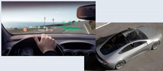
ヘッドアップディスプレイは運転状況に合わせ、適切な情報を車のフロントガラスに表示し、視線を落とさずに運転することができ、ドライバーの安全に寄与します。また電気自動車の普及に伴い、近年需要が拡大しているパノラマルーフ向けカラー膜やリアガラス向けデザイン膜は、遮光だけでなくUVをカット、さらに、車内の静粛性を高める遮音グレードや近赤外線を吸収する遮熱グレードを採用することで車内温度上昇の抑制にも寄与します。
