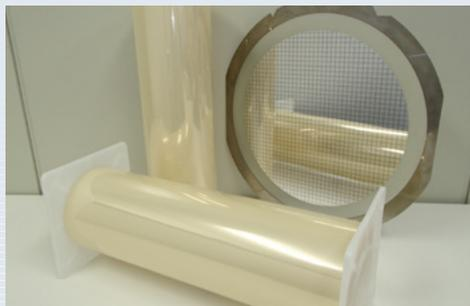
高い接着性と易剥離を両立させたUV剥離テープです。UV照射によりテープと被着体の間にガスを発生させ、密着力をゼロにして簡単に剥がすことが可能です。通信技術の進化に伴って微細化・薄膜化するウエハを、損傷なく加工することができます。
