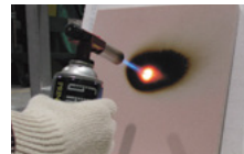
不燃材料認定ウレタン系現場発泡断熱材
