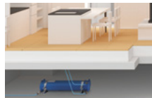
飲料水貯留システム
