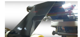
フィルム型ペロブスカイト太陽電池のロール・ツー・ロール生産
