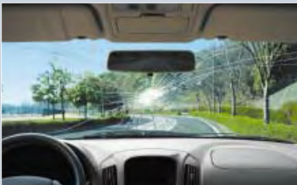
ガラス片も飛散せず貫通もしない
