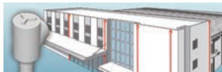
「陸屋根高排水システム」サイフォン式の高排水システムが陸屋根（平面屋根）の幅広い建物にも対応を拡大
