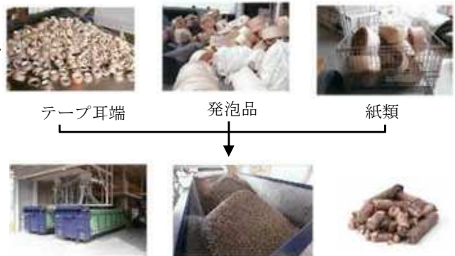
場内で燃料ペレット化し、二酸化炭素の排出削減効果の大きいクリーンエネルギーとして供給
