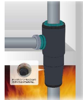
熱で配管内部が閉塞し延焼を防止する 「プラスチック単管式排水システム」
