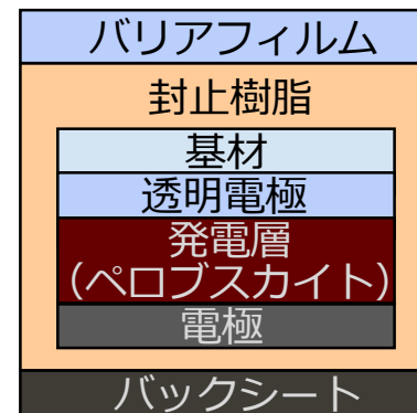
〈ペロブスカイト太陽電池 断面構造〉
