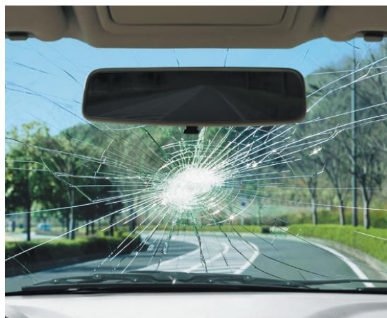
合わせガラス用中間膜 (衝突時飛散防止)
